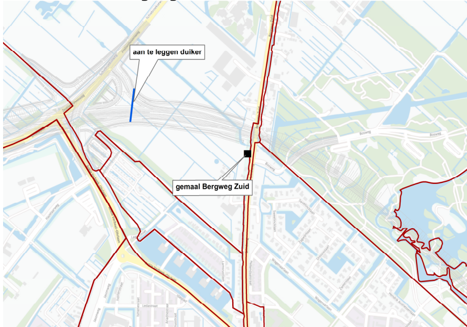
Afbeelding 5.12. In stand houden aanvoer route naar gemaal Bergweg-Zuid met een duiker onder de A16 Rotterdam
