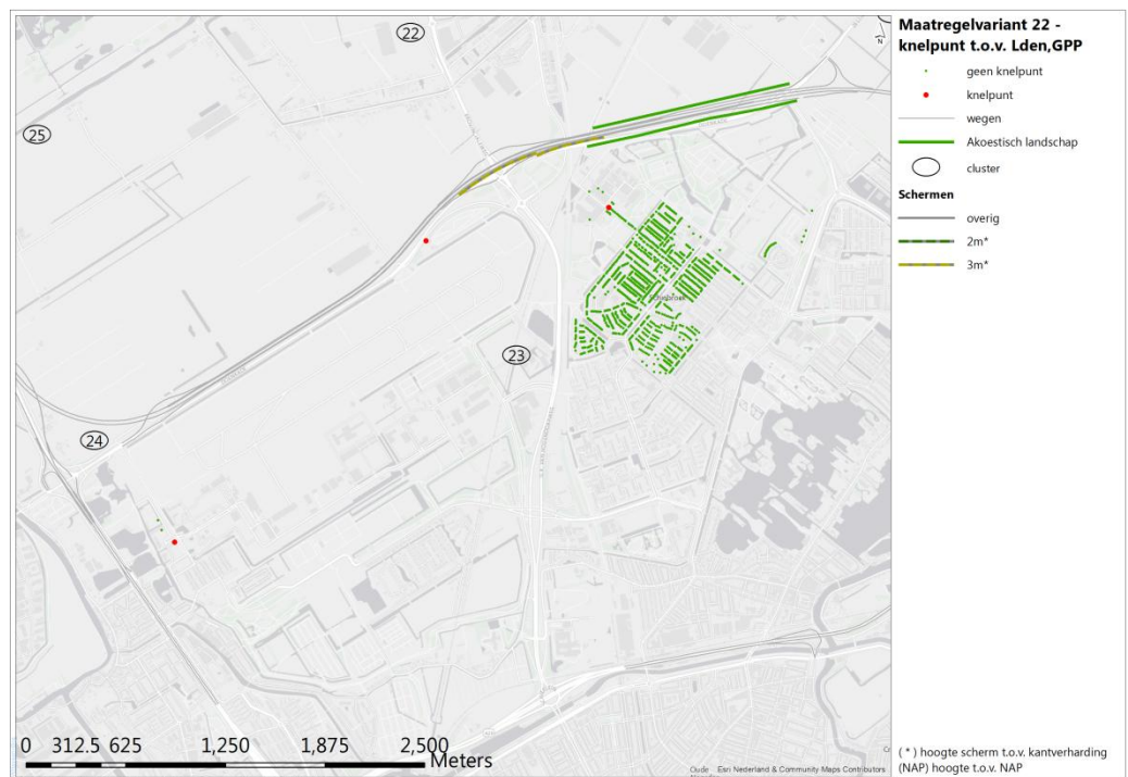
Afbeelding 5.25. Overschrijdingen toetswaarden en situering geluidschermen bij cluster 23a variant 22
