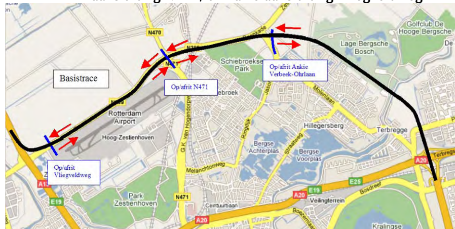
Figuur 5.9.6.1: Halve aansluiting Ankie Verbeek - Ohrlaan, volledige aansluiting N471 en halve aansluiting Vliegveldweg
