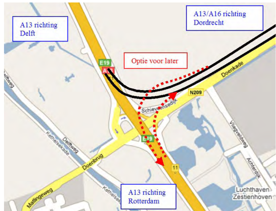
Figuur 5.13.1: Verbindingsbogen aansluitingen Rijksweg A13
