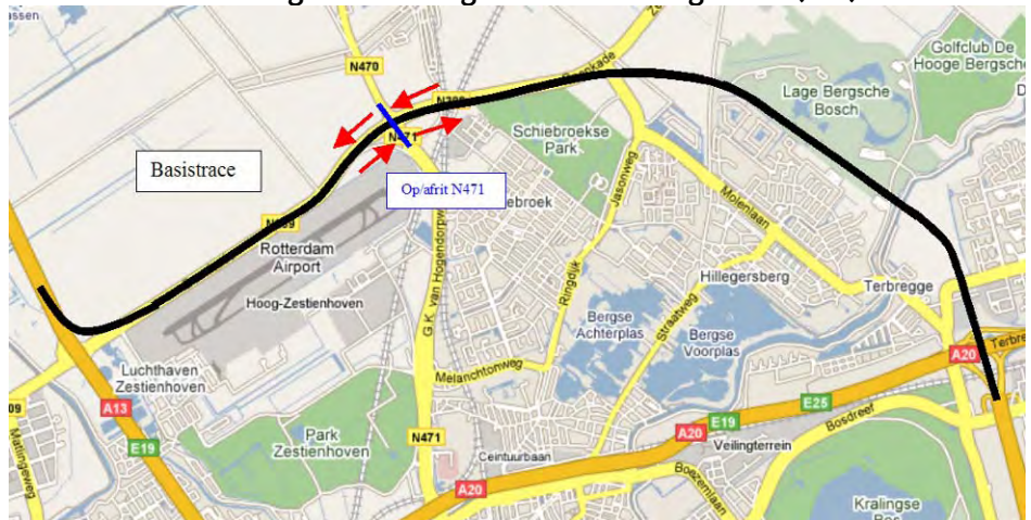
Figuur 5.9.3.1: Volledige aansluiting provinciale weg N471 (7.2)
