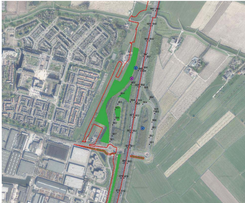
Figuur 10.1d. Locaties met jaarrond beschermde nesten van buizerd en sperwer (blauwe en paarse stip) bij km 58.6 en 58.5 welke vallen binnen het ruimtebeslag van het (O)TB-ontwerp (rode lijn). Nieuwe boomaanplant conform het (O)TB ontwerp en Landschapsplan is aangegeven met de groene vlakken.
