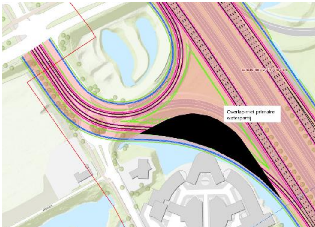
Afbeelding 6.11 Nieuw tracé bij aansluiting Rosmalen kruist met primaire waterpartij. Alternatieven A2 en C. [Dit is een nog niet ingepast ontwerp dat het worstcase ruimtebeslag laat zien. In volgende fasen van het project worden de ontwerpen nog nader ingepast en uitgewerkt.]
