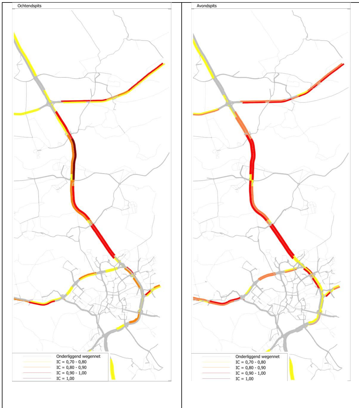
Afbeelding 5.13 Verhouding tussen intensiteit en capaciteit op het hoofdwegennet in de ochtend- en avondspits in Referentie 2040 Laag
