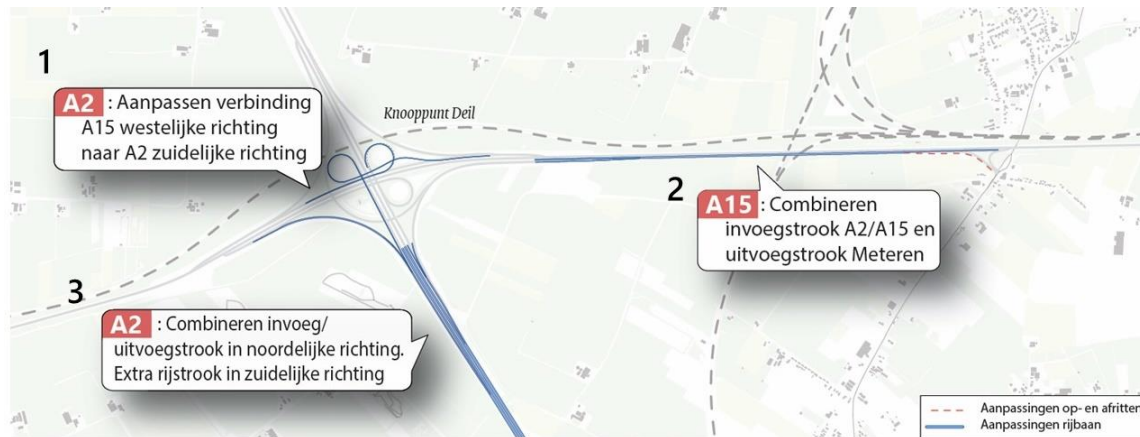
Afbeelding 2.4 Visualisatie ontwerp alternatief A - knooppunt Deil
