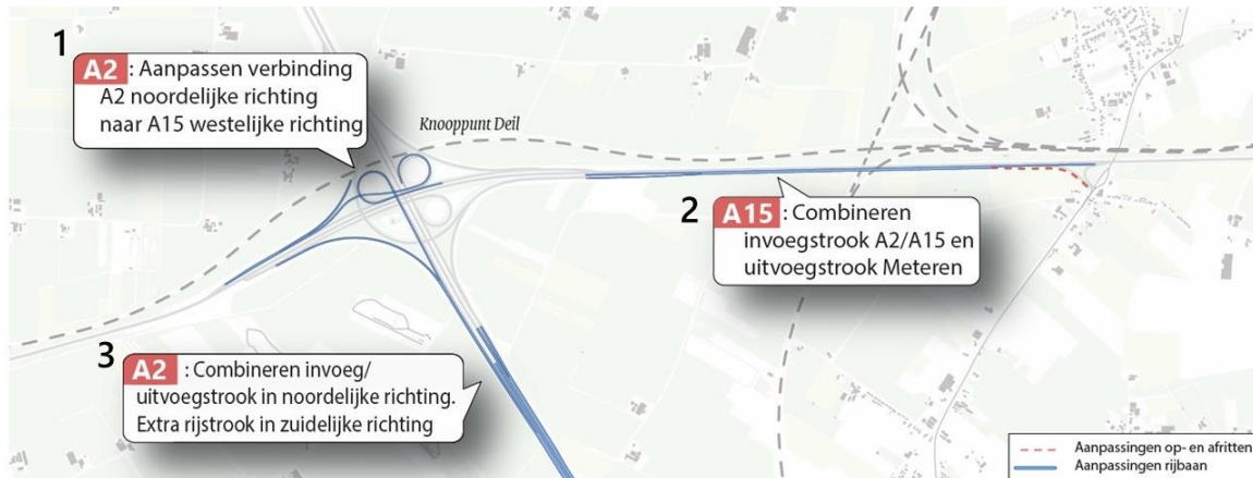
Afbeelding 2.2 Visualisatie ontwerp alternatief 0+ - knooppunt Deil
