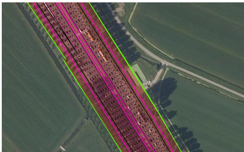
Afbeelding 6.2 De verbrede A2 HRB Li komt binnen het areaal van het bergbezinkbassin
