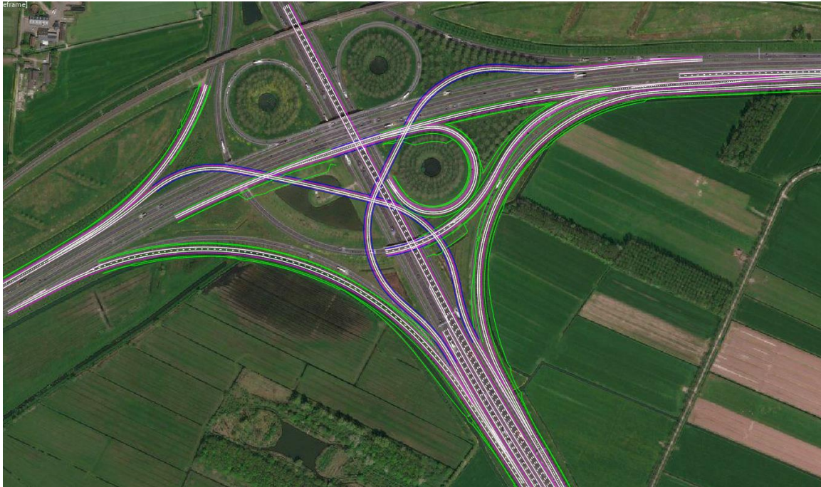
Afbeelding 5.56 Ontwerp knooppunt Deil
