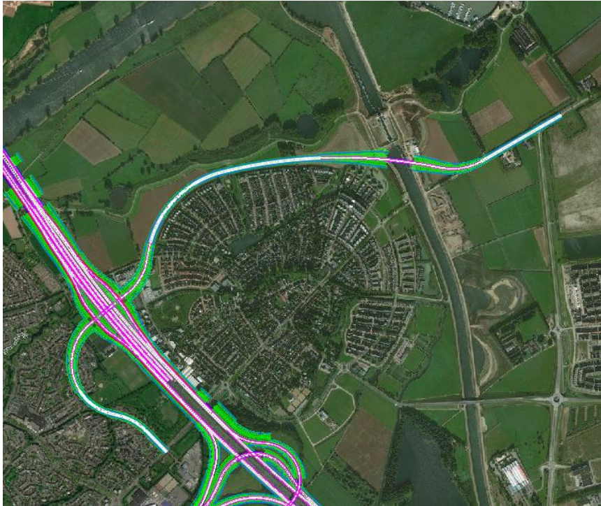
Afbeelding 5.52 Ontwerp nieuwe aansluiting met verbindingswegen
