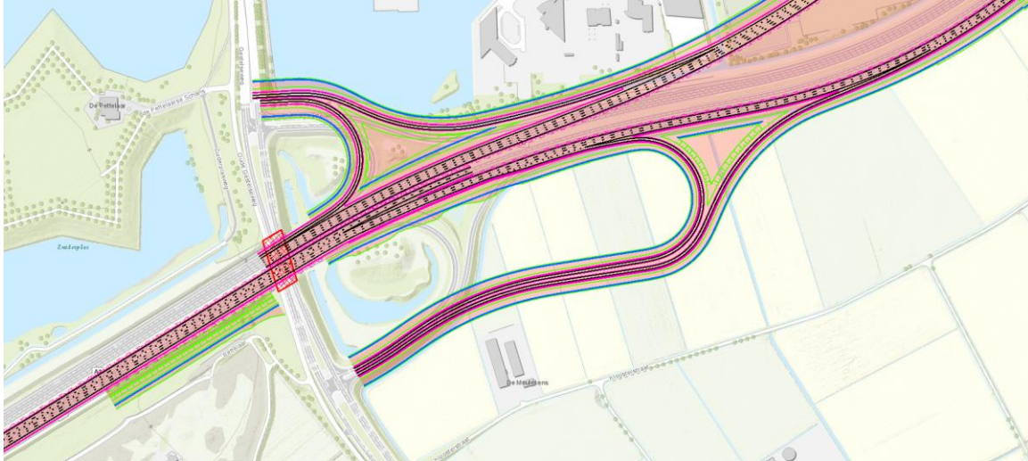
Afbeelding 6.19 Toerit aansluiting Sint-Michielsgestel Li bevat onverwachte krappe boog
