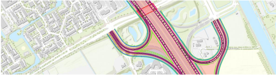
Afbeelding 6.12 Aansluiting Rosmalen Re raakt bestaande bebouwing en sluit niet aan op bestaand OWN
