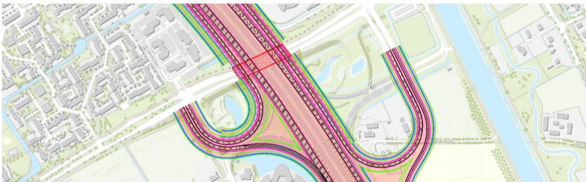
Afbeelding 6.54 Aansluiting Rosmalen Re raakt bestaande bebouwing en sluit niet aan op bestaand OVN
