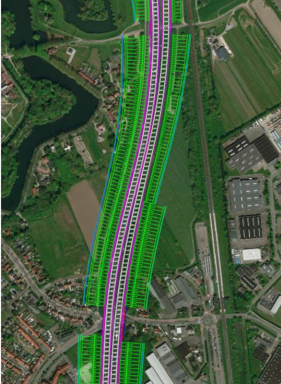
Afbeelding 5.37 Ontwerp nabij overgang symmetrische verbreding - asymmetrische verbreding
