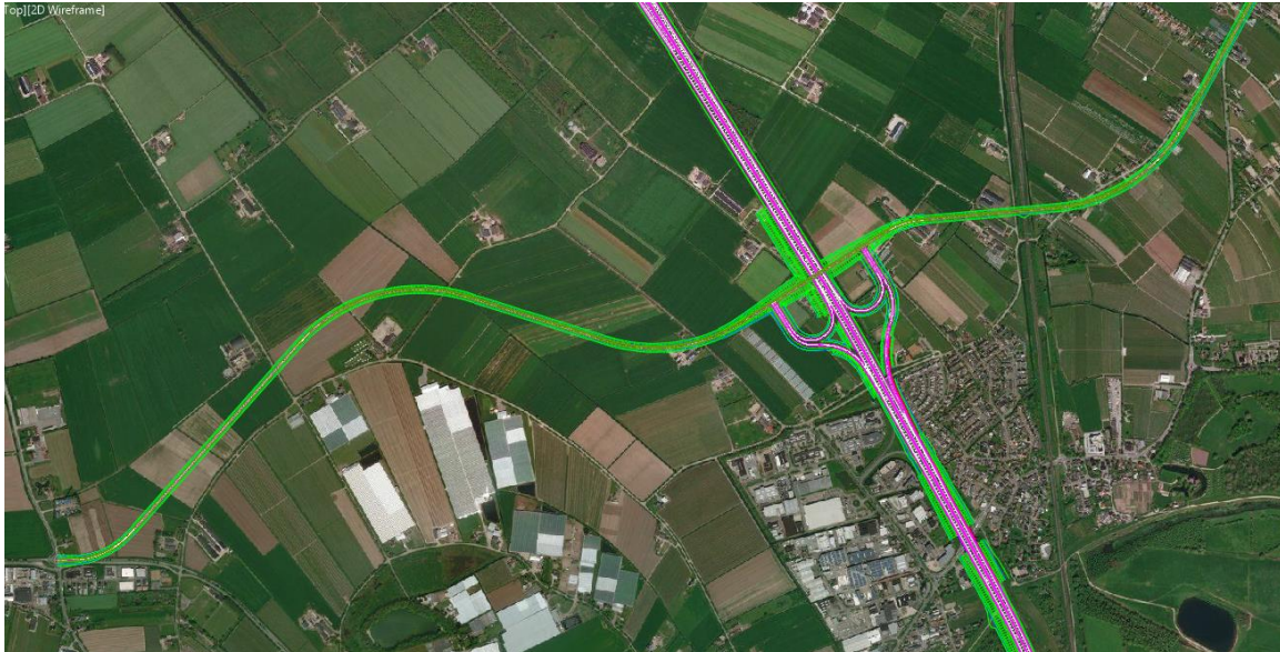
Afbeelding 5.20 Ontwerp nieuwe randweg en aansluiting Waardenburg
