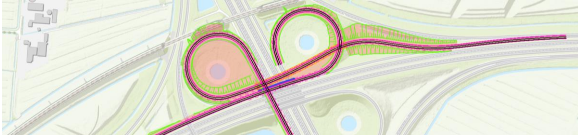
Afbeelding 6.20 Centraal viaduct in knooppunt Deil moet verbreed worden
