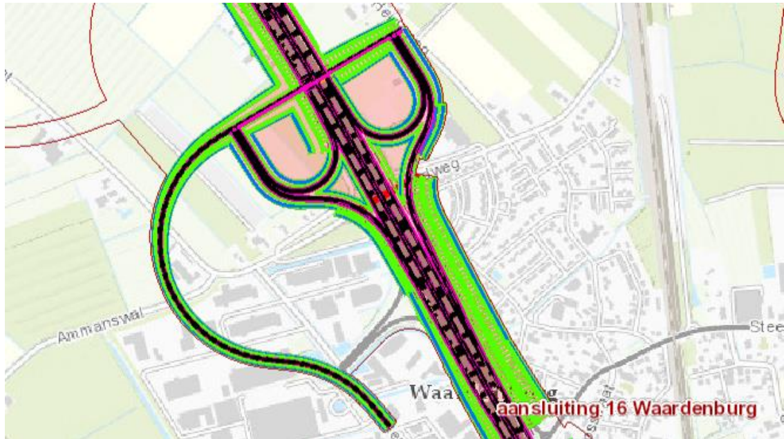
Afbeelding 6.10 Nieuwe aansluiting Waardenburg. Nieuwe verbindingen met onderliggend wegennet snijden door het regionaal watersysteem. Alternatief C [Dit is een nog niet ingepast ontwerp dat het worstcase ruimtebeslag laat zien. Naar aanleiding van de knelpuntenanalyse wordt de oostzijde van de nieuwe aansluiting omgeklapt naar het noorden. In volgende fasen van het project worden de ontwerpen nog nader ingepast en uitgewerkt. Bovendien vraagt de inpassing van het onderliggend wegennet (de ontsluitingswegen van en naar de nieuwe aansluiting) nader onderzoek, dit wordt nog niet vastgelegd in het voorkeursalternatief.]
