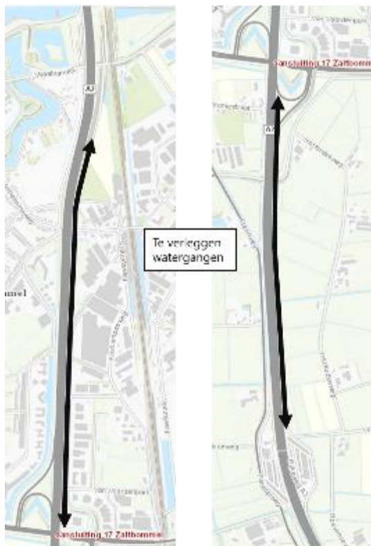
Afbeelding 6.13 Alternatief C: Watergangen aan de oostzijde van de A2 moeten worden verlegd (links: deelgebied Zaltbommel, rechts: deelgebied De Lucht)
