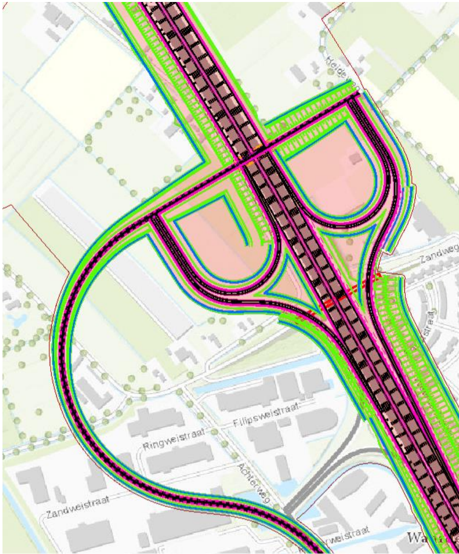
Afbeelding 6.3 De verplaatste aansluiting Waardenburg. De nieuwe aansluiting ligt ten noorden van het dorp; de huidige aansluiting vervalt. Alternatief C [Dit is een nog niet ingepast ontwerp dat het worstcase ruimtebeslag laat zien. Naar aanleiding van de knelpuntenanalyse wordt de oostzijde van de nieuwe aansluiting omgeklapt naar het noorden. In volgende fasen van het project worden de ontwerpen nog nader ingepast en uitgewerkt. Bovendien vraagt de inpassing van het onderliggend wegennet (de ontsluitingswegen van en naar de nieuwe aansluiting) nader onderzoek, dit wordt nog niet vastgelegd in het voorkeursalternatief.]
