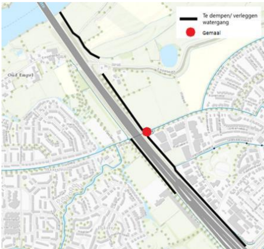
Afbeelding 6.12 Watergangen parallel aan de A2 dienen verplaatst te worden in de alternatieven A, B en C. Uitsluitend het gedeelte ten zuiden van het gemaal aan de oostzijde is een primaire watergang
