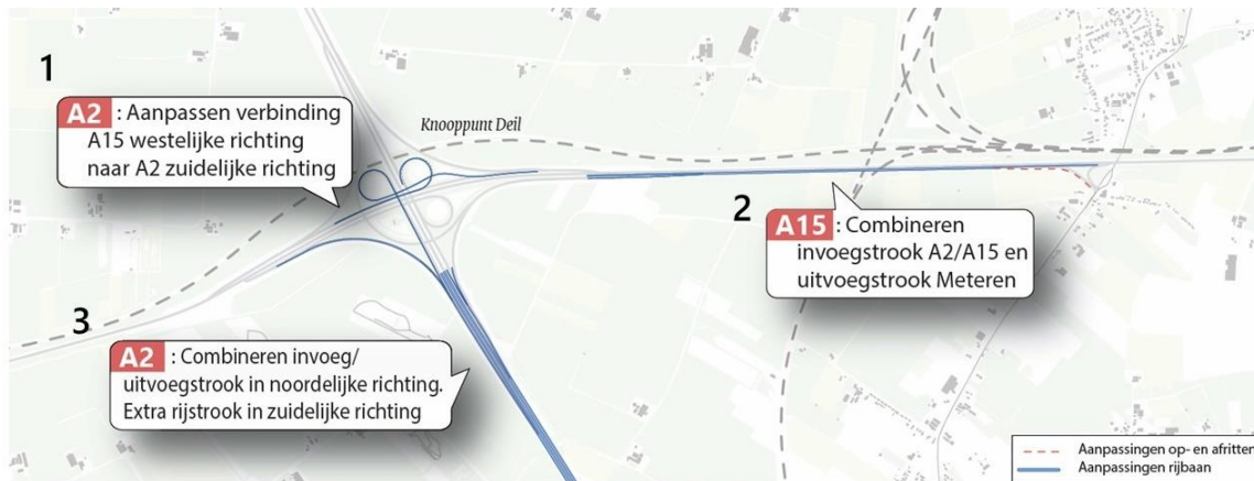
Afbeelding 2.4 Visualisatie ontwerp alternatief A - knooppunt Deil
