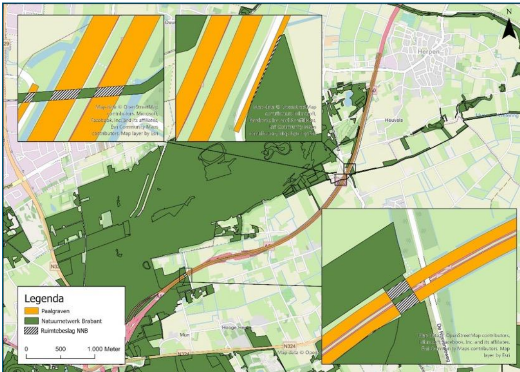
Afbeelding 9.3.3. Ligging van beide alternatieven van traject Paalgraven ten opzichte van het NNB en het ruimtebeslag. Op één locatie overlapt het plangebied met een bestaand ecoduct (rechtsonder) wat niet als ruimtebeslag wordt gezien. Op een andere locatie loopt een watergang onder het plangebied door (linksboven) wat ook niet als ruimtebeslag wordt gezien.
