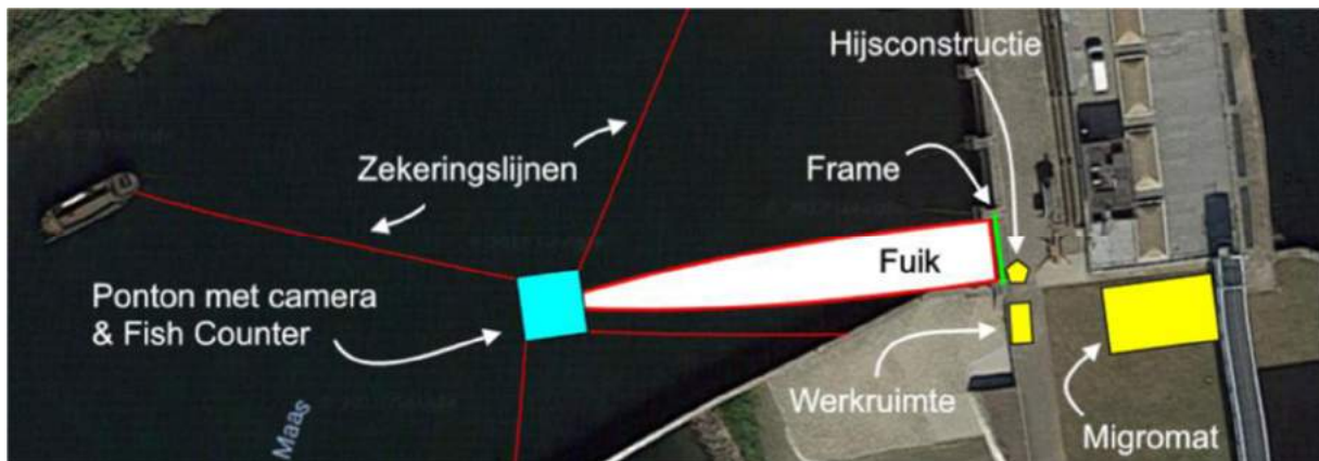
Figuur 52 Overzicht van de monitoringsconstructie (rechtsboven de WKC) (bron: da Graca & Kemper, 2019).
