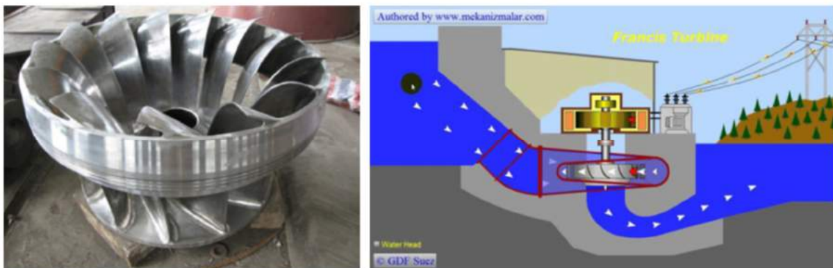
Figuur 86 Voorbeeld van een Francis rotor (links) en opstelling in een WKC (rechts).
