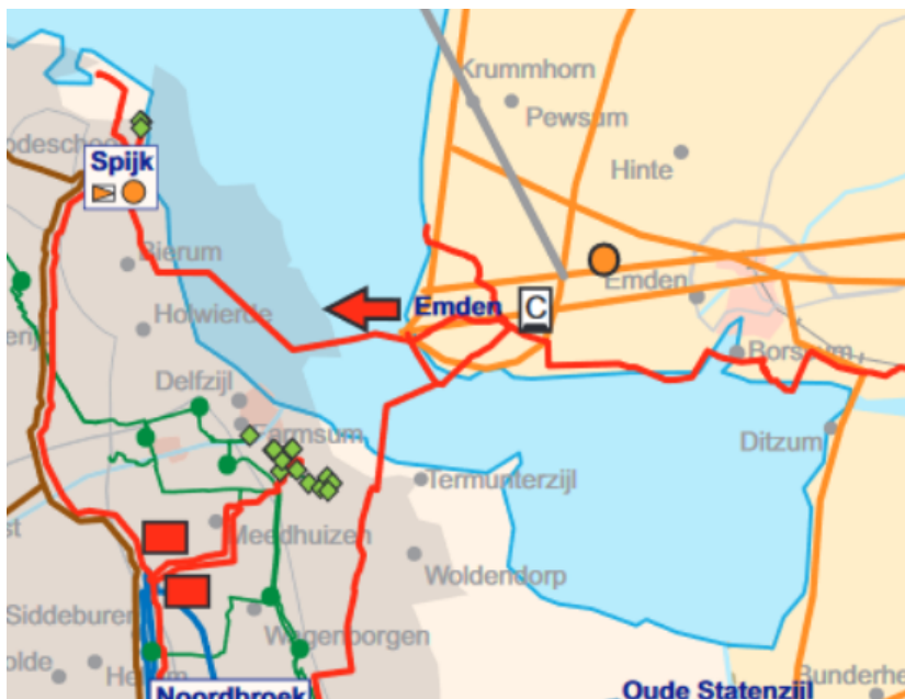
Figuur 4-6 Uitsnede transportnetwerk van GTS met daarop de Eems-Dollard (in rood leidingen van GST) (Gasunie, 2015)
