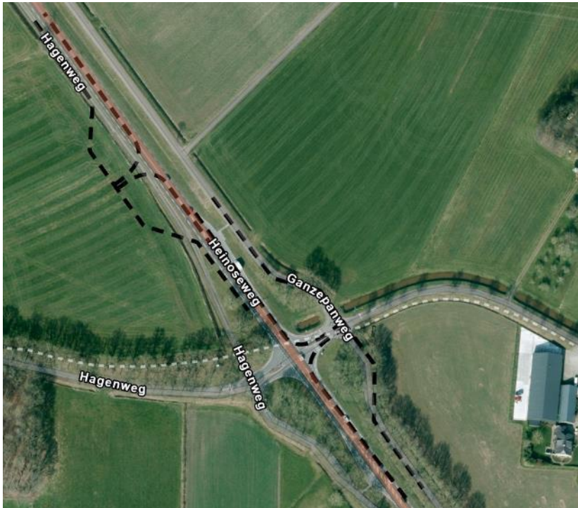
Figuur 14 Schets Hagenweg, variant 1H bajonetkruispunt
