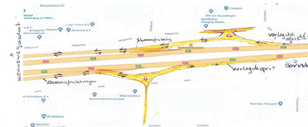
Figuur 1 Verleggen en verlengen op- en afrit A15/Nieuweweg vanuit en richting Gorinchem
