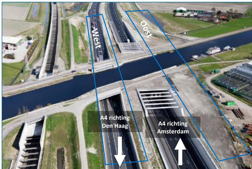
Figuur 2.1: Huidige situatie Ringvaartaquaducten en indicatief het ruimtebeslag van de varianten west en oost.
