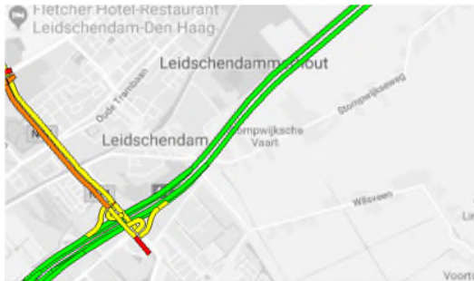
Figuur 4-5: Gemiddelde afgewikkelde rijnsnelheid voor personenauto's in de avondspits (situatie in 2030 zonder project, referentiesituatie)
