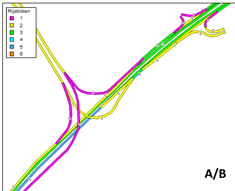
Figuur 3-6: Aantal rijstroken A4 ter hoogte van Zoeterwoude-Dorp en Hofvliet in de plansituatie 2030 (geen verschil tussen alternatief A en alternatief B)
