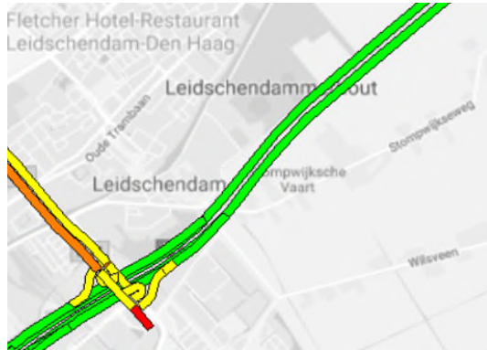
Figuur 4-15: Gemiddelde afgewikkelde rijnsnelheid voor personenauto's in de avondspits (situatie in 2030L zonder project, referentiesituatie)
