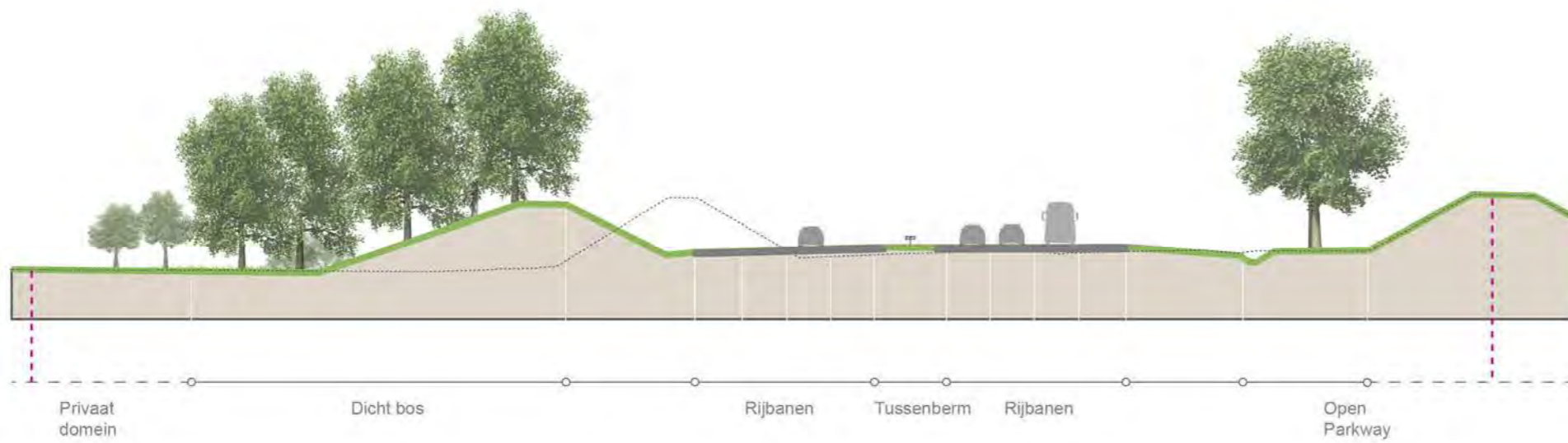
Dwarsprofiel Grondwal - Oud Roosteren I SCHAAL 1:500 KM 227700
