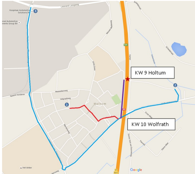
Figuur 4-11 Locaties bij KW 9 Holtum en alternatieve route via KW 10 Wolfrath in rood en blauw. Ten oosten van de A2 vallen beide routes samen. In paars het nieuw te realiseren onderhoudspad (fiets/voetgangers en landbouwverkeer).
