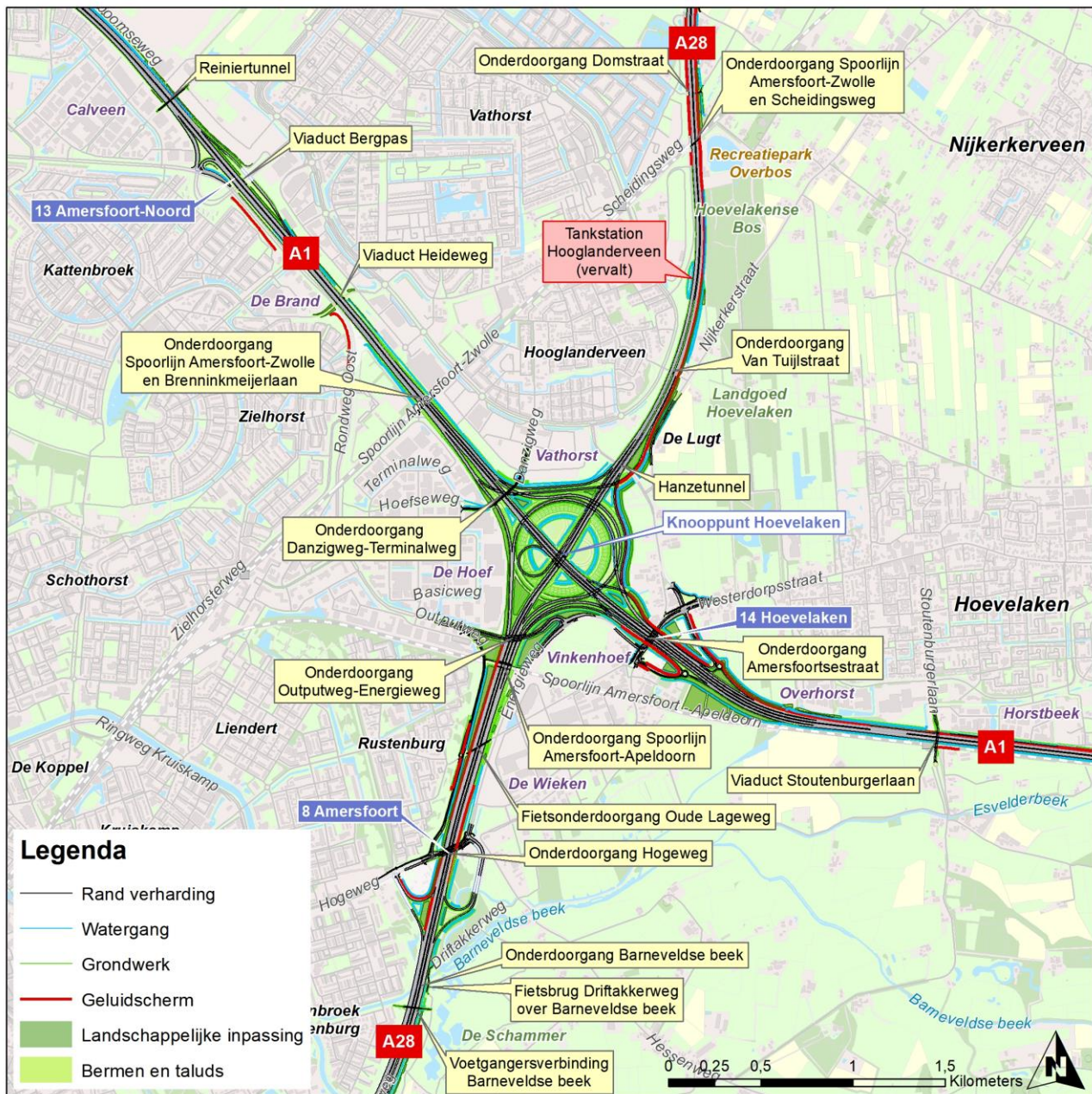
Figuur 22 Kunstwerken en aanpassingen bij knooppunt Hoevelaken en aansluitende delen A1 en A28
