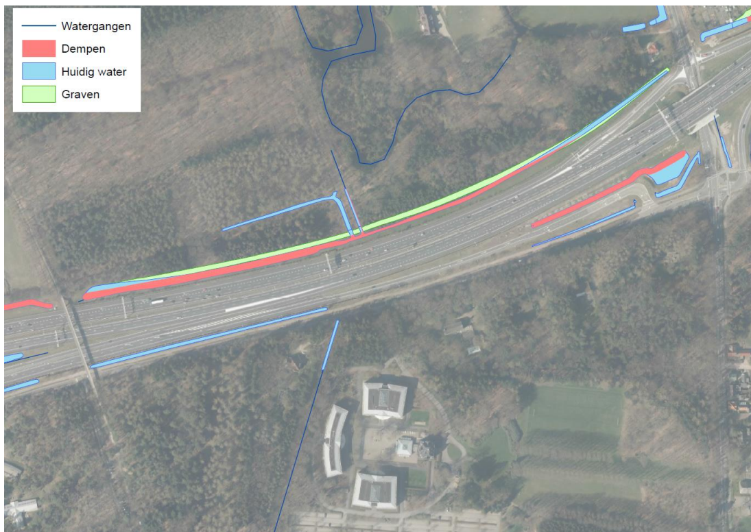
Figuur 38 De te dempen watergang gelegen aan de noordwestzijde van de rijksweg A28
