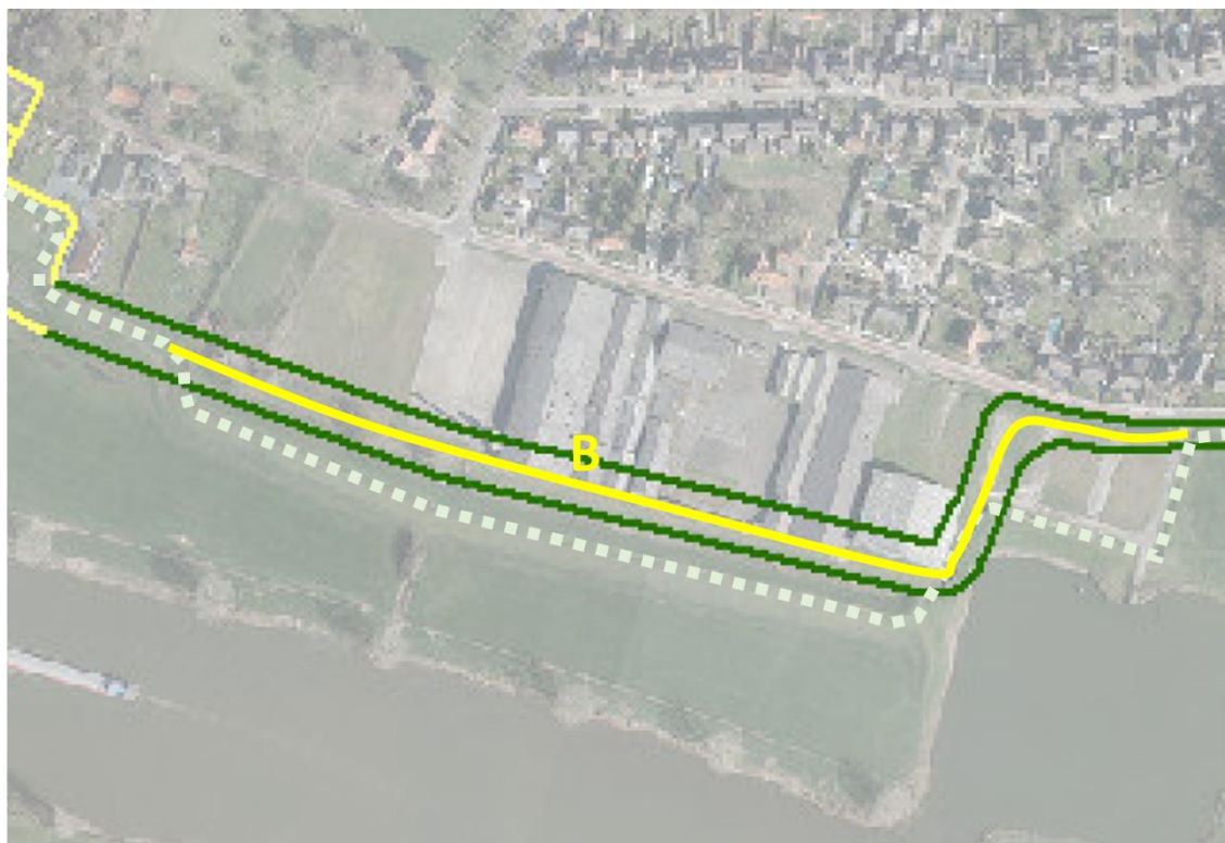
Figuur 14 Ruimtebeslag tracévariant (B) Steenfabriek met huidige dijk gestippeld
