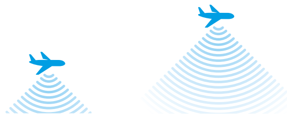
Figuur 1: Hoe hoger een vliegtuig vliegt, des te lager de geluidsniveaus op de grond worden, maar ook hoe breder het gebied waarover het geluid wordt uitgespreid. Dit is vereenvoudigd weergegeven in deze figuur. Om een bepaalde reductie in geluidniveau op de grond te krijgen moet de route van een hoger vliegend vliegtuig verder verplaatst worden dan van een lager vliegend vliegtuig.
