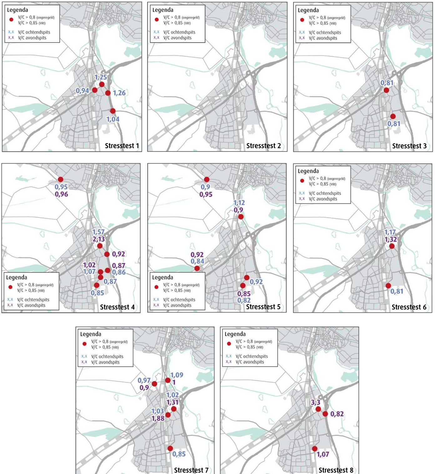
Figuren 4.19 a-g. Aanvullende afwikkelingsknelpunten op kruispuntniveau, ten opzichte van afsluitingsvariant 2, voor de acht stresstesten.
