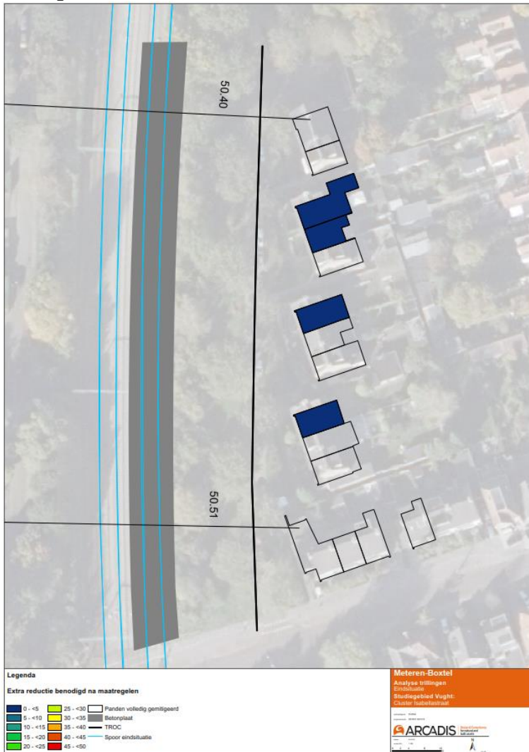
Maatregelen set Betonplaat onder 2 sporen + TROC
