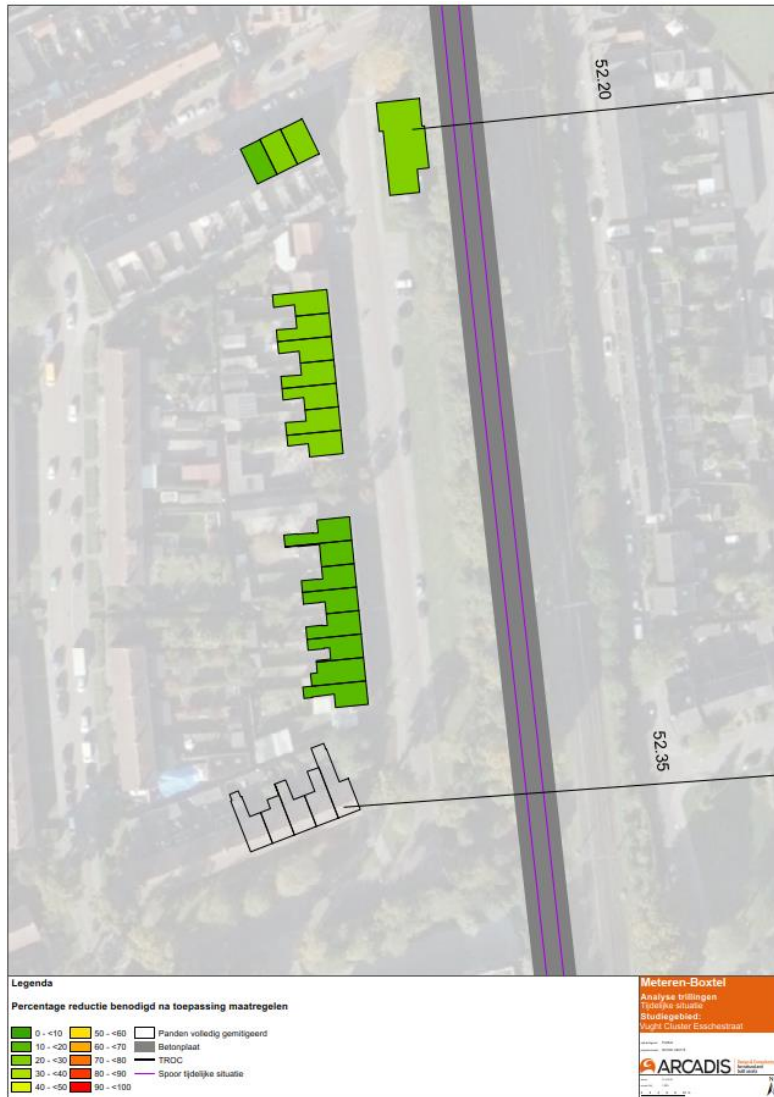
Maatregelenbetonplaat onder 2 sporen
