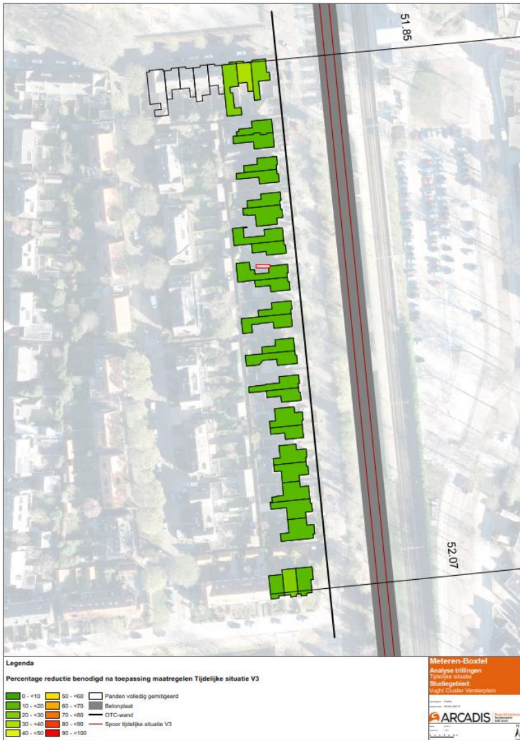
Maatregelset betonplaat onder 2 sporen + TROC
