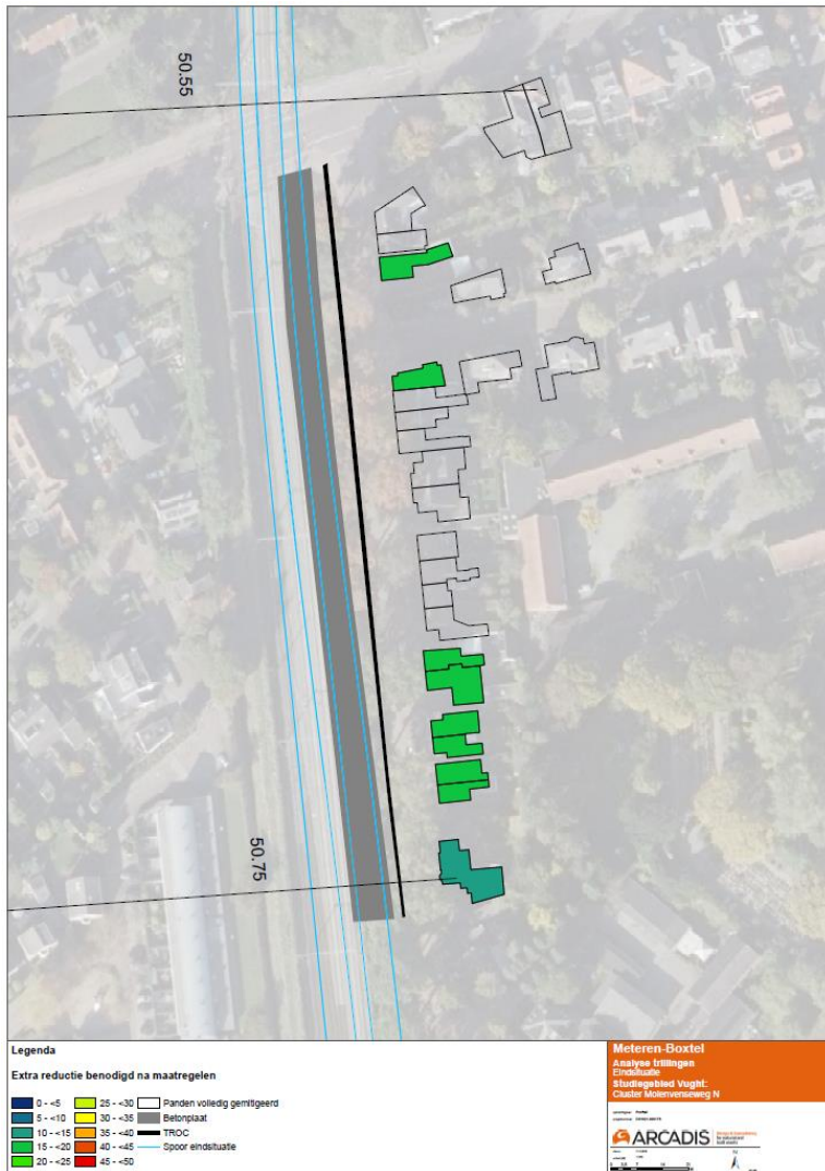
Maatregelenset Betonplaat onder 2 sporen +TROC
