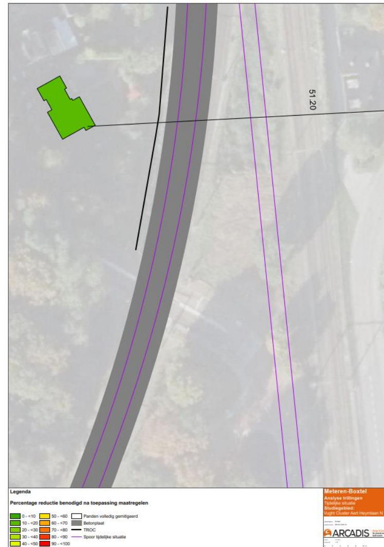
Maatregelen set Betonplaat voor 2 sporen en TROC
