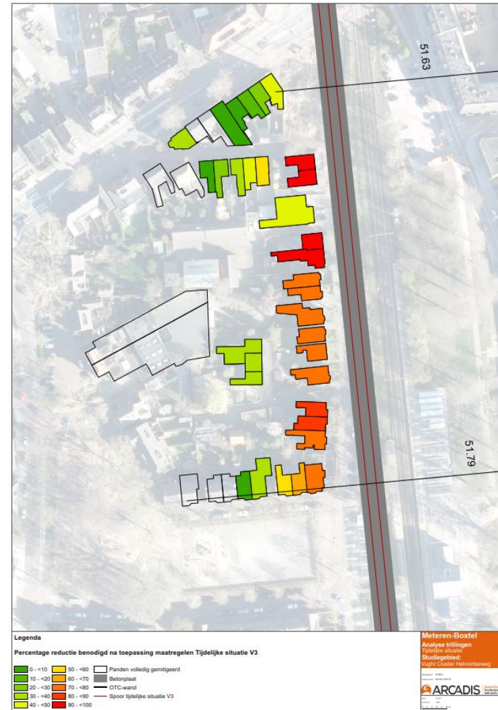
Maatregelen set betonplaat onder 2 sporen
