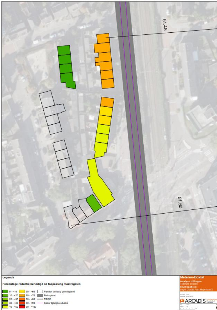
Maatregelen set betonplaat onder 2 sporen
