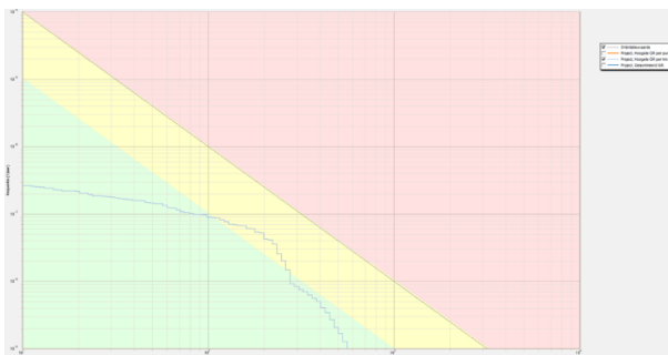
Figuur 2: De fN-curve voor de kilometer N65 met het hoogste groepsrisico in de huidige situatie.
