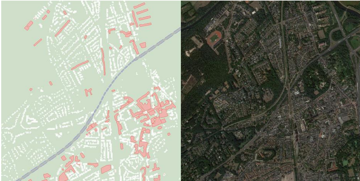
Figuur 1: Links is de bevolking en de route in de tijdelijke situatie weergegeven. In de tijdelijke situatie is de route alleen ter plaatse van de verlegging van de route gemodelleerd als weg buiten de bebouwde kom. Rechts is een luchtfoto van het werkveld van 2000 meter x 2000 meter weergegeven.
