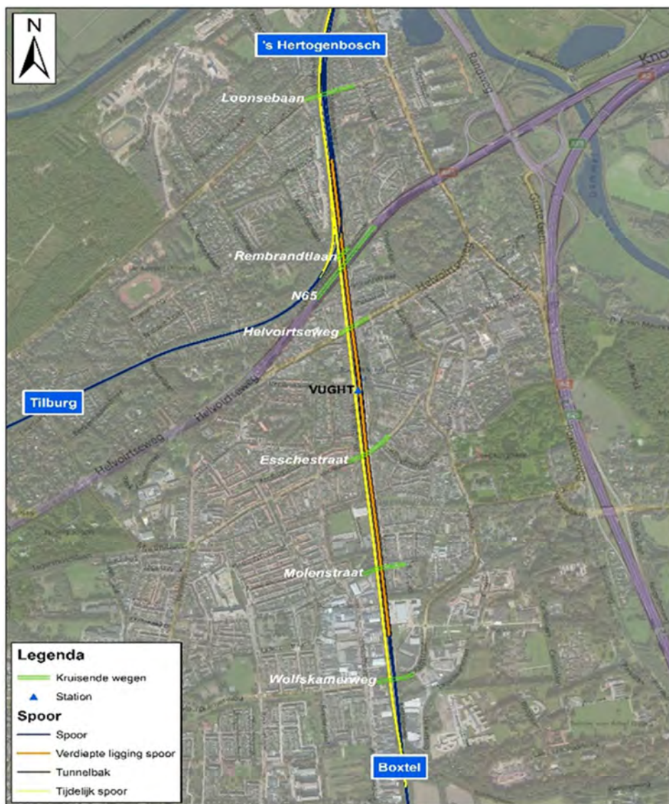
Figuur 3: Verdiepte ligging in Vught met ligging tijdelijk spoor
