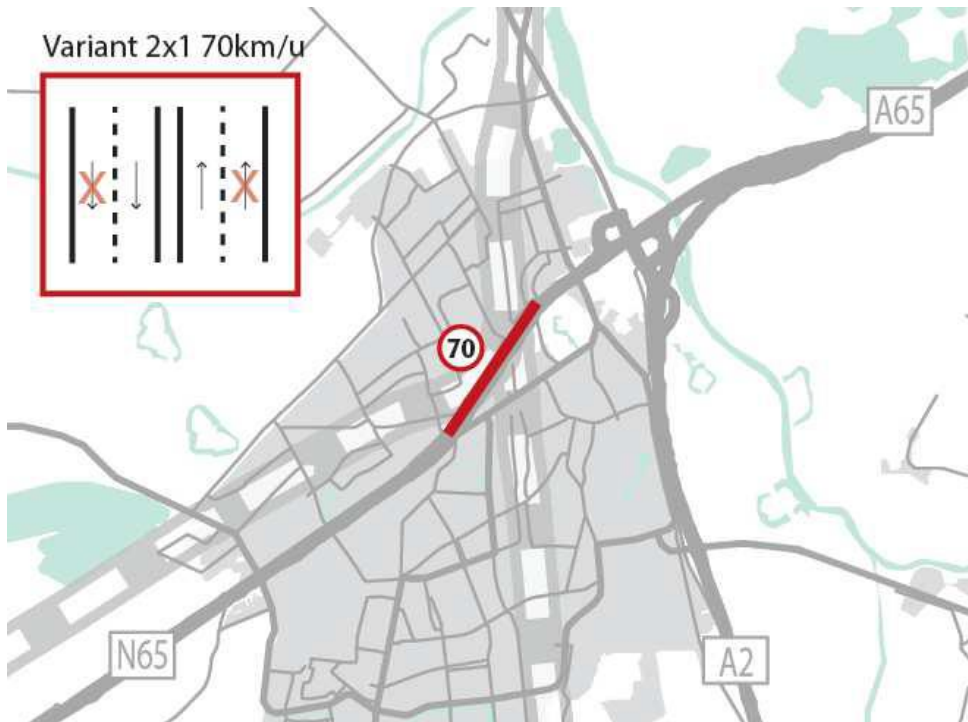
Figuur 4: Schematische weergave bypass (2x1 variant met 70km/u)
