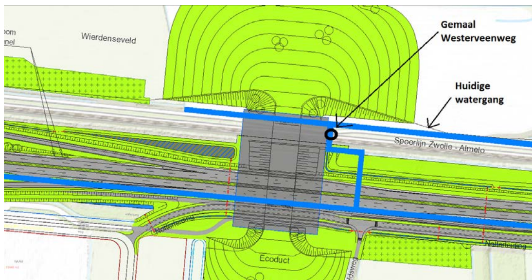
Figuur 5.3 Gemaal Westerveenweg en de afvoerende watergang naar het zuiden (huidige situatie)
