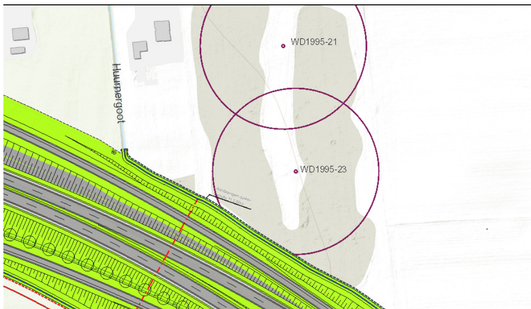
Figuur 5.1 De watergang voor afwatering van naastgelegen perceel loopt door de 60-meter cirkel van waterwinput 23
