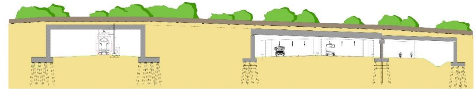
Figuur 6.22 Principe lengtedoorsnede verbindend ecoduct
