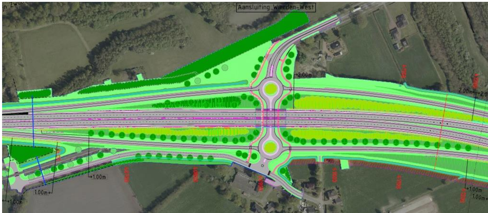
Figuur 6.9 Inrichting aansluiting Wierden-West met bossages en bomenrijen vanuit zuiden richting Wierden. Tevens begeleidende beplanting als verbinding voor vleermuizen en in aansluiting naar de faunapassage (blauwe dwarsstreep)
