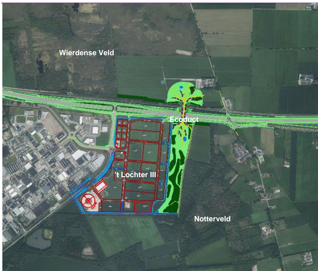
Figuur 4.6 Ligging ecoduct & aansluitende ecozone ten opzichte van natuurgebieden en toekomstig bedrijventerrein 't Lochter III (verkeveling in rood)
