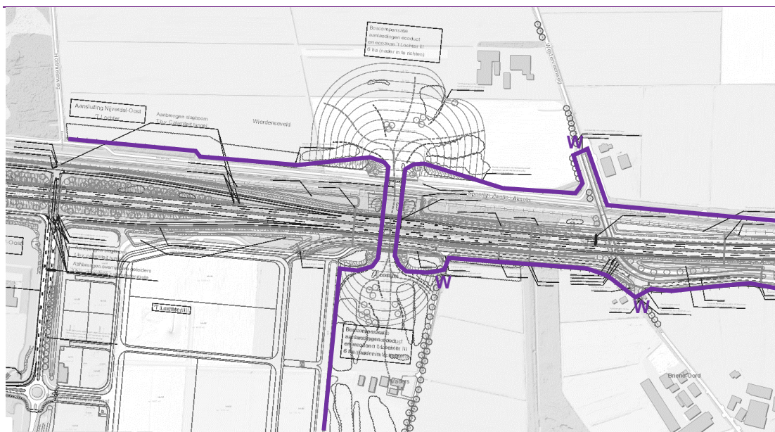
Figuur 4.7 Indicatieve ligging aan te brengen combirasters (paarse lijn) en wildroosters (W) bij ecoduct
