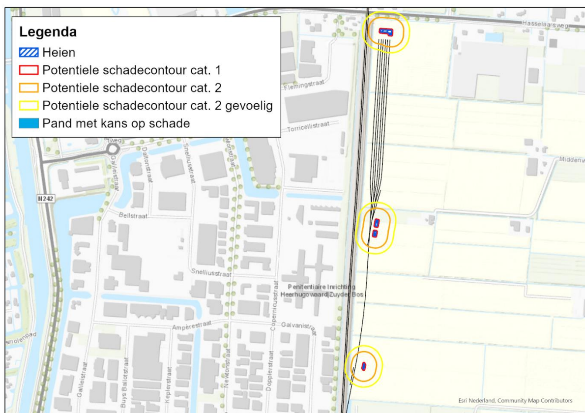
Figuur 69 Schadecontouren opstelsterrein Heerhugowaard De Vaandel
