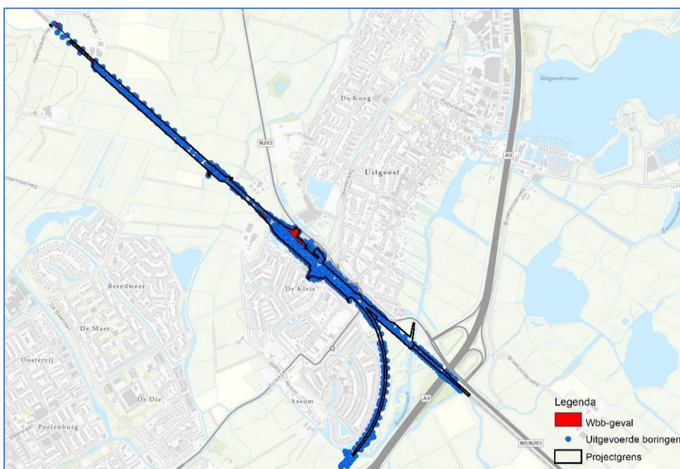
Figuur 3.3 Inventarisatie uitgevoerde boringen en Wbb-gevallen station en emplacement Uitgeest ( www.railramps.nl )
