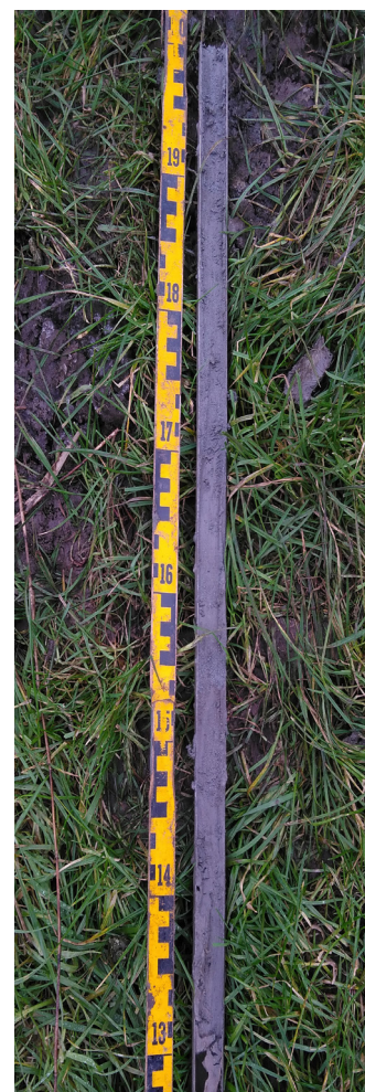
Afbeelding 12. Boring uit onderzoeksgebied 'Watercompensatie'. Vanaf 1,20 m -mv is een zandig homogeen pakket zichtbaar met kleibandjes.
