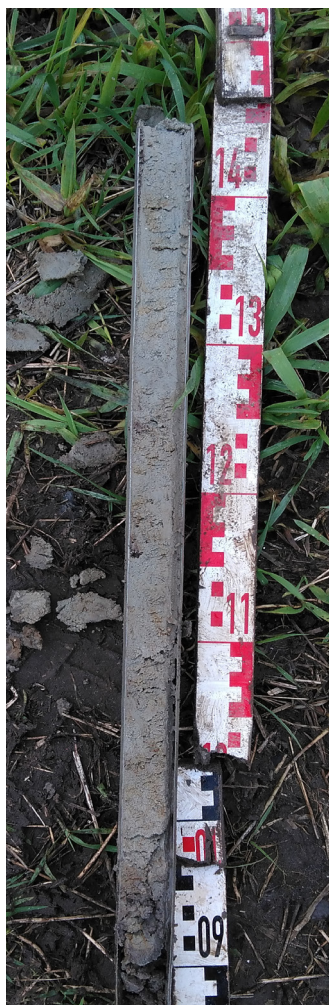
Afbeelding 11. Boring uit onderzoeksgebied 'Driehoek van Assum'. Na een geroerd pakket is vanaf 1,00 -1,20 m -mv een zandig gevlekt pakket zichtbaar.
