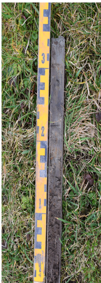
Afbeelding 9. Links: Boring B100 met een rijp kleipakket met roestvlekken in de top en vanaf 0,40-0,50 m -mv een zandig pakket met onderin natuurlijke kleibandjes. Rechts: Dinoloket boring iets ten zuiden van AMK-terrein 1871.
