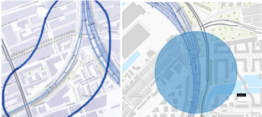
Figuur 2-2 Contour met een straal van 220 m rond een boog (links) en contour met een straal van 220 m rond een wissel (rechts)
