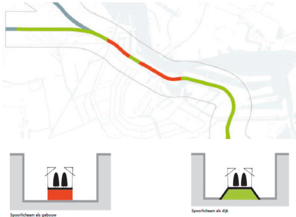
Figuur 13-2. Twee types randen van het spoorlichaam (Ruimtelijk Kader PHS Amsterdam, (gemeente Amsterdam) (zuidzijde afgeknipt)
