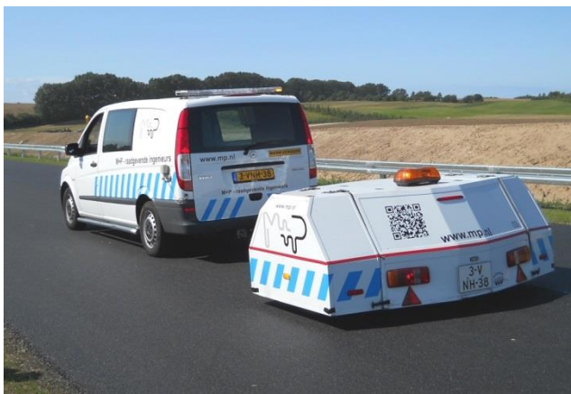
figuur 6 Foto van de M+P CPX-trailer gedurende een meting
