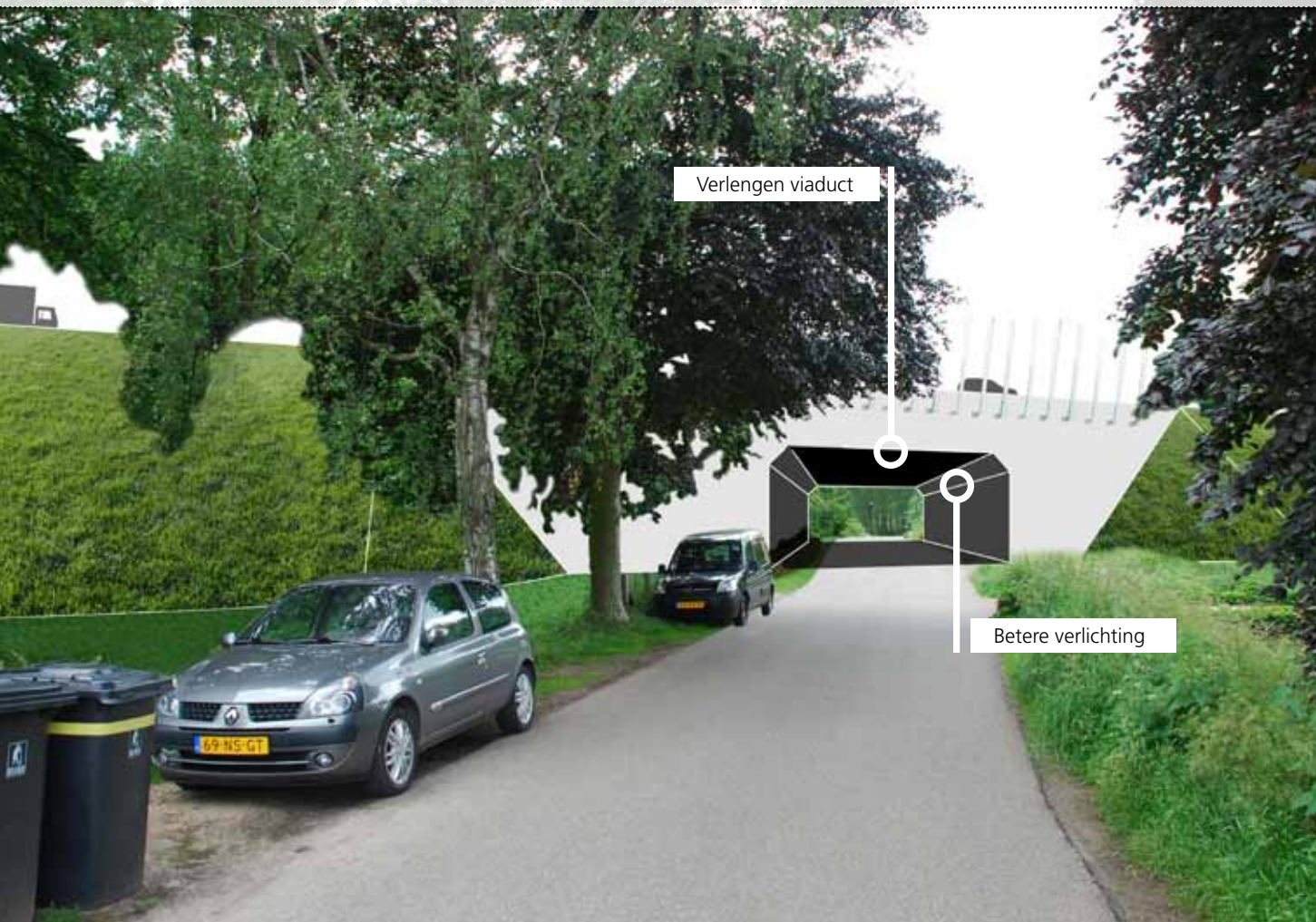
Afbeelding 2.2 Optimaliseren van het verlengde viaduct.
