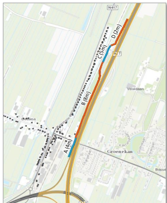
Figuur.5 Geluidbeperkende maatregelen bij de Koningin Wilhelminaweg in het ontwerp-tracébesluit
