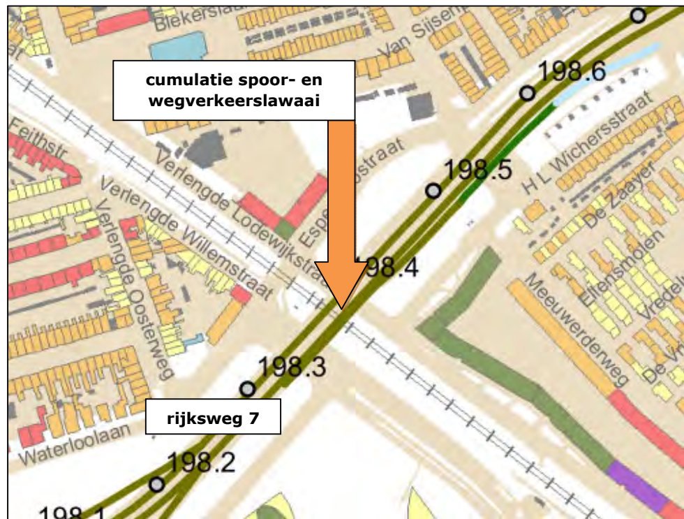
Figuur 3 Ligging van het spoorwegtraject en de locatie waar sprake is van cumulatie
