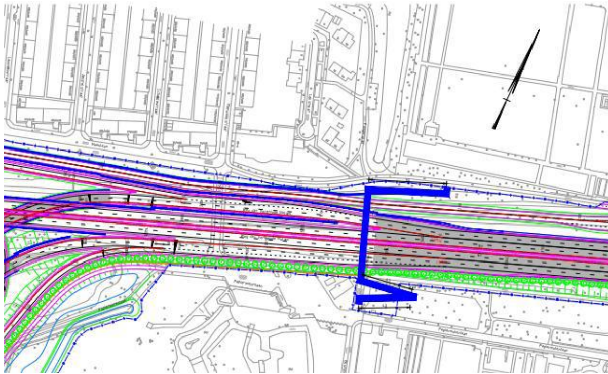
Figuur 8: Lengte en globaal ruimtebeslag fietstunnel ter plaatse van het Boutenspad (slingers in hellingbanen en Verbindingsweg naast de Maaslaan verhoogd)
