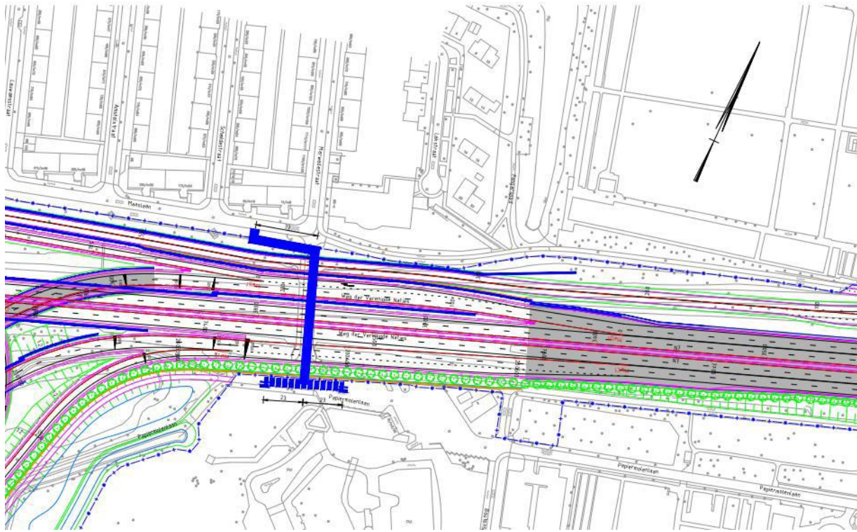
Figuur 4: Lengte en globaal ruimtebeslag fietstunnel ter plaatse van huidige fietstunnel (slingers in hellingbanen en Verbindingsweg naast de Maaslaan verhoogd)
