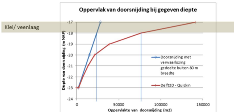
Figuur 2.15. Variatie van de oppervlakte van de doorsnijding van de bodemligging van SO-IJ Variant 3 met diepte, afgeleid uit het gedetailleerde stromingsmodel van het Noordzeekanaal bij IJmuiden (Bijlsma en Weiler, 2017).
