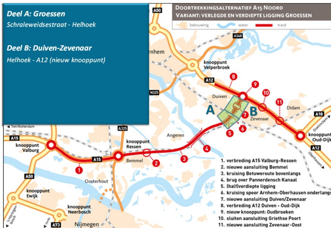
Figuur 1 | Locaties van de geplande (half)verdiepte ligging bij Groessen en Duiven-Zevenaar in het Ontwerp-Tracébesluit (concept, bron: www.via15.nl).
