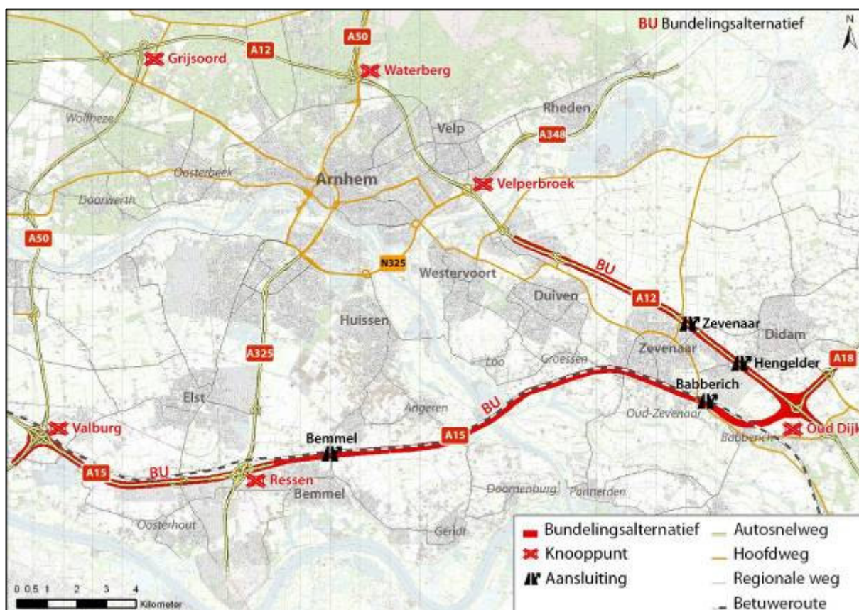
Afbeelding 3-2 Schematisch overzicht alternatief Bundeling
