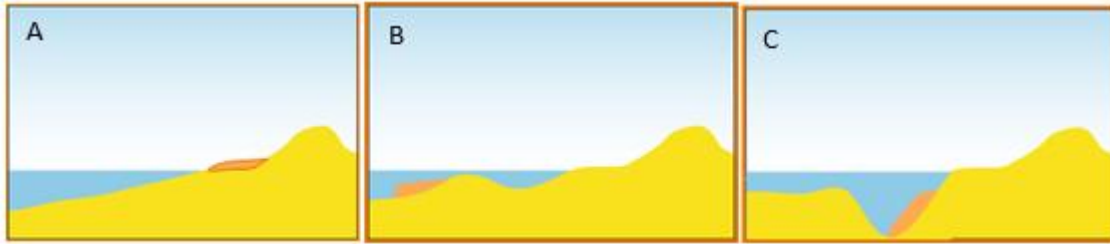
Figuur S.2 Strandsuppletie (A), vooroeversuppletie (B) en geulwandsuppletie (C)
