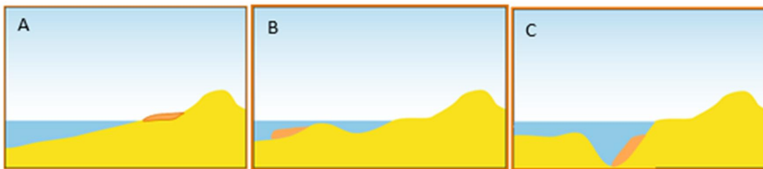
Figuur 6.1 Strandsuppletie (A), vooroever-suppletie (B) en geulwandsuppletie (C)
