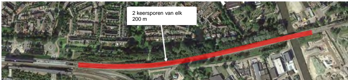
Afbeelding 11 De positionering van de keersporen Diemen ten oosten van Station Diemen Zuid.
