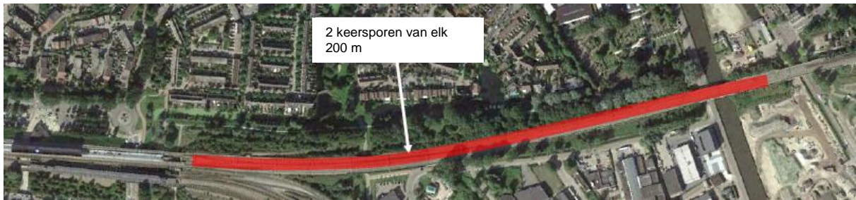
Afbeelding 12 De positionering van de keerspooren Diemen ten oosten van Station Diemen Zuid.
