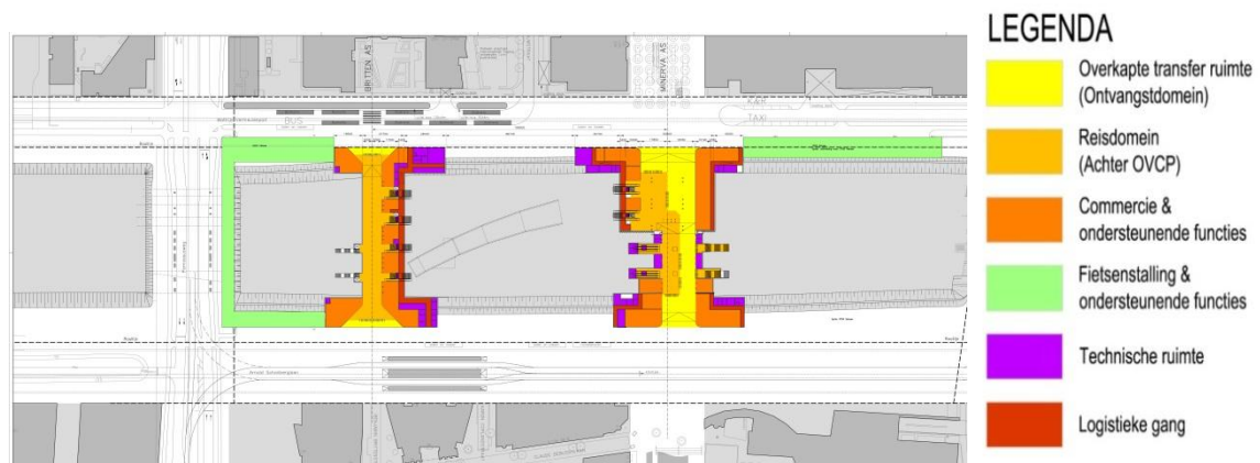
Afbeelding 9 Schematische weergave van de variant OVT Minervapassage met behoud treindeel (OVT-MP BT).
