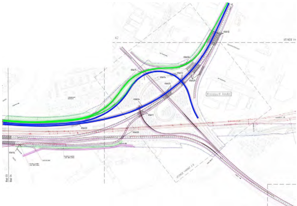
Figuur 4: Bereikbaarheid hoofd- en parallelbanen (voor de hulpverlening) rechts vanaf knooppunt Amstel (blauw = hoofdstructuur / groen = parallelstructuur).
