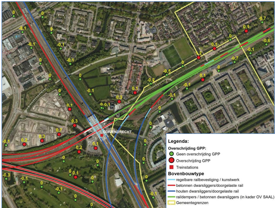
Afbeelding 5: Overzicht ligging aanwezige bovenbouwtypes
