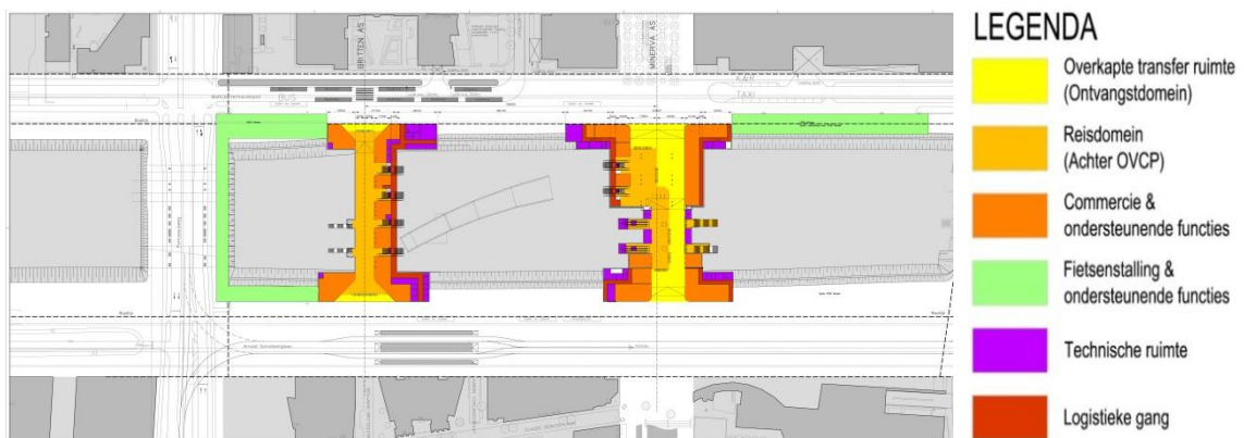
Afbeelding 10 Schematische weergave van de variant OVT Minervapassage met behoud treindeel (OVT-MP BT).
